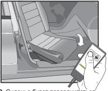
3. Сиденье будет поворачиваться наружу, пока нажата левая кнопка на пульте управления. При достижении крайнего разворота наружу сиденье автоматически фиксируется.
